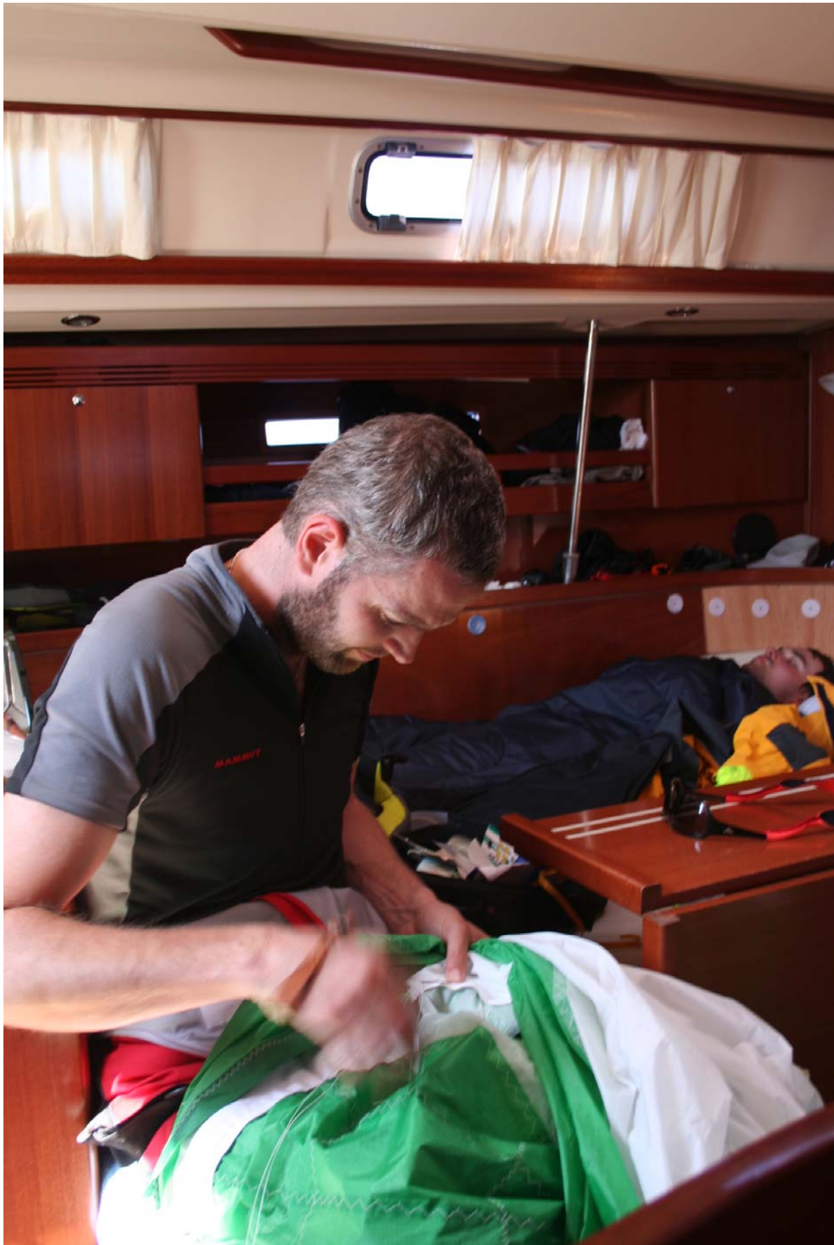
Es wurde sogar ein Stück Handtuch zur Liekverstärkung eingearbeitet. Wir hatten zwar ursprünglich viel Spinnakerklebebander und Garn mit, aber bei der dritten
